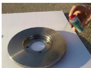
**BSS®** einfach direkt auf die gereinigte Bremsscheibe aufsprühen
