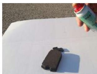
**BSS®** ebenfalls auf die Bremsbeläge aufsprühen
